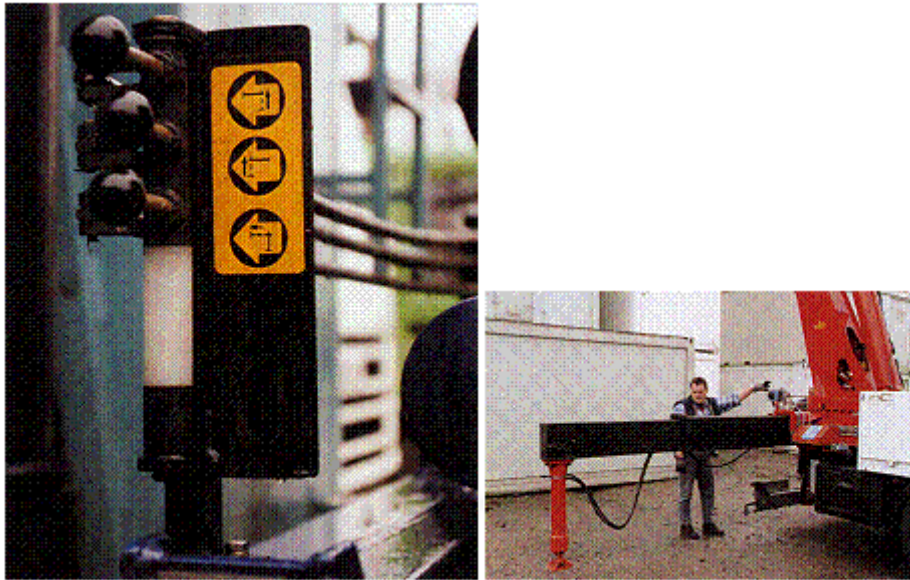
Abb. 85, 86: Steuern der Abstützungen nur von der Seite, die eingesehen werden kann
