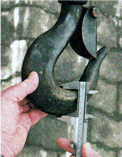
Abb. 261: Messen der Steghöhe " h_2 " zur Kontrolle der Abnutzung
