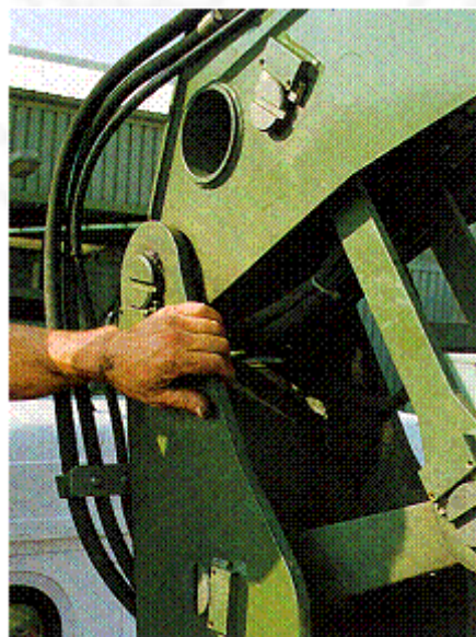
Abb. 71, 72: Durch Hochstand werden Gefahrstellen an Ausleger-Hubmechanik erreichbar
