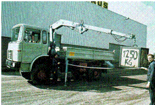
Abb. 123: Prüfen der Standsicherheit
