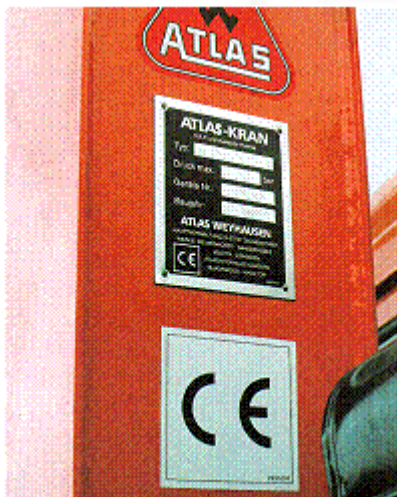
Abb. 92: Fabrikschild und CE-Kennzeichnung
