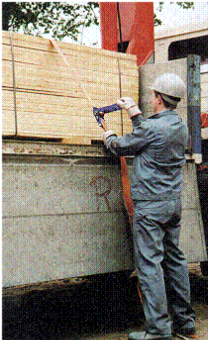
Abb. 274: Ladung sichern durch Verzurren
