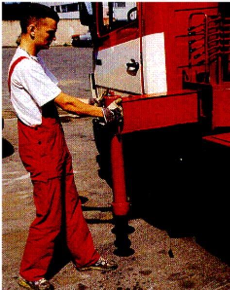
Abb. 39: Gefahrquelle: Handbewegter Abstützträger
