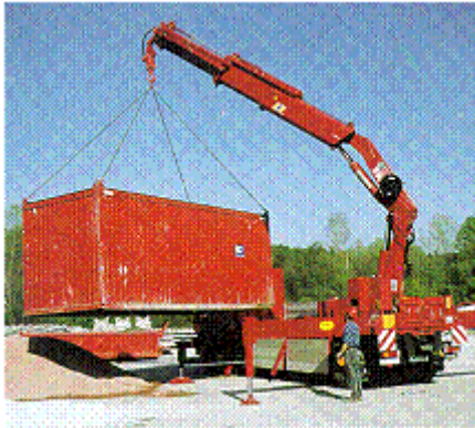
Abb. 252: Beladener Container unzulässig mit Neigungswinkeln an den oberen Eckbeschlägen angeschlagen
