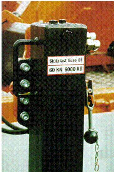
Abb. 164: Stützkraftangabe auf dem Stützzyylinder
