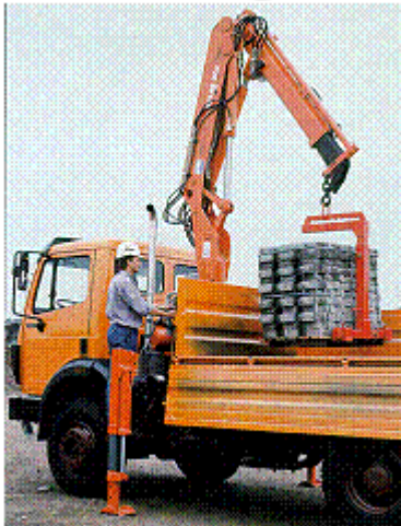
Abb. 171: Belastungsangaben gelten für den Aufhängepunkt am Auslegerkopf; Kranhaken und Palettengabel gehören zur Last
