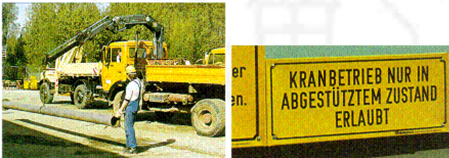
Abb. 149, 150: Lkw-Ladekrane dürfen im allgemeinen nicht freistehend betrieben werden
