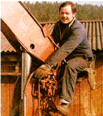
Abb. 27: Scherstelle zwischen Hubarm und Kransäule
