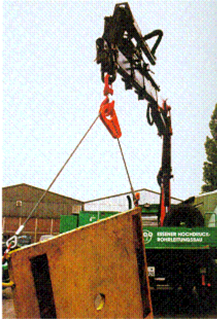
Abb. 244: Ausgleicher für unsymmetrische Lasten
