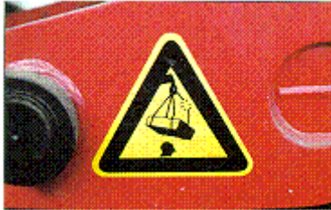
Abb. 176: Warnung vor schwebender Last
