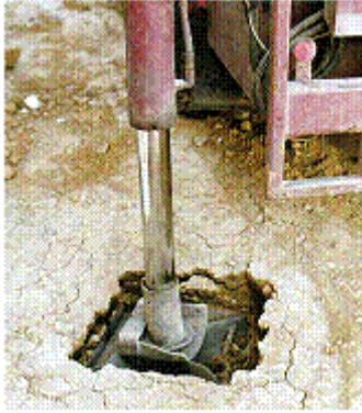
Abb. 161: Zu kleine Abstützfläche führt zum Einsinken der Stütze
