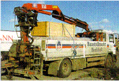
Abb. 146: Beim Ablegen des Auslegers über der Last Durchfahrthöhen beachten
