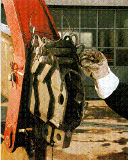
Abb. 115: Sichern der Schubstücke durch Verbolzen
