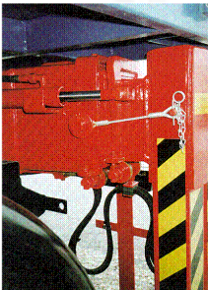
Abb. 271: Sichern der Abstützung gegen unkontrolliertes Ausfahren
