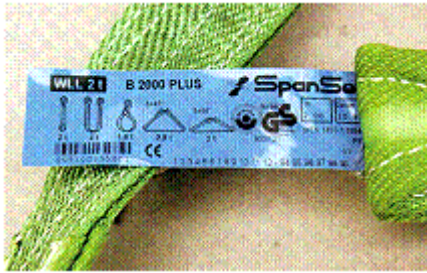
Abb. 208: Kennzeichnung eines Hebebandes mit Endschlaufen
