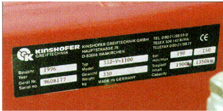
Abb. 187: Fabrikschild mit Herstellerangaben und CE-Kennzeichnung
