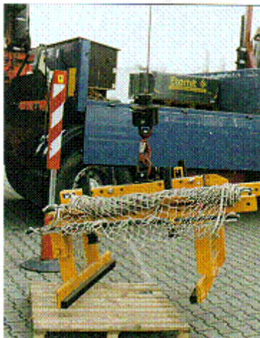
Abb. 189: Steingreifer mit Schutznetz gegen Herabfallen der Last
