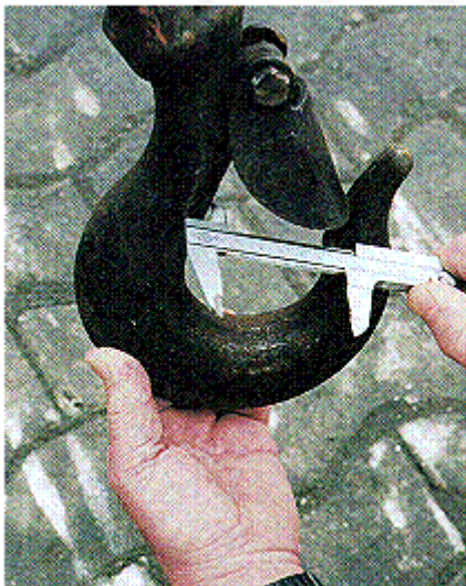
Abb. 260: Messen des Maßes " a_2 " zur Kontrolle von Aufweitung
