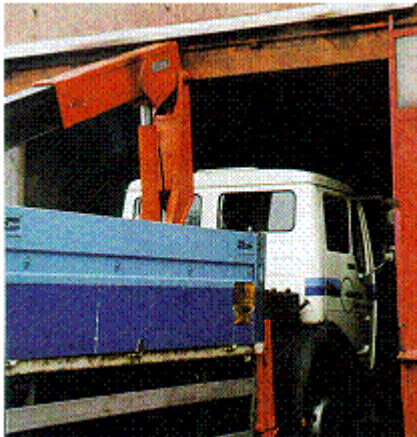
Abb. 99: Nicht in Transportstellung gebrachter Kran überschreitet das zulässige Lichtraumprofil
