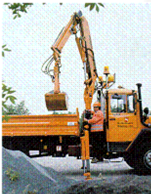
Abb. 193: Schüttgutverladung mit Zweischaalengreifer
