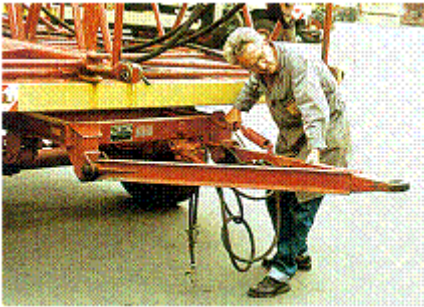
Abb. 276: Einstellen der Anhängerzuggabel auf Kupplungshöhe
