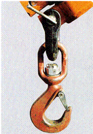
Abb. 59: Hakensicherung sowie ordnungsgemäße Befestigung des Hakens mittels Hakenmutter und Splint
