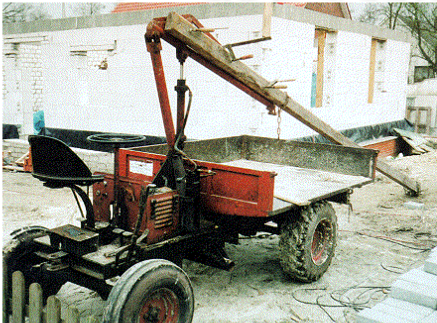
Abb. 23: Lebensgefährlich: Eigenmächtige Änderung der Krankonstruktion
