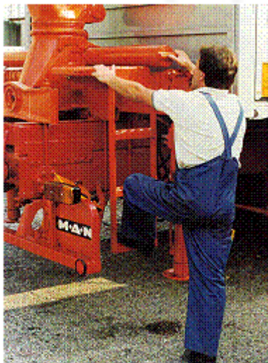
Abb. 79: Sicheres Begehen von Aufstiegen erfordert Drei-Punkt-Abstützung
