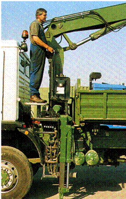
Abb. 71, 72: Durch Hochstand werden Gefahrstellen an Ausleger-Hubmechanik erreichbar
