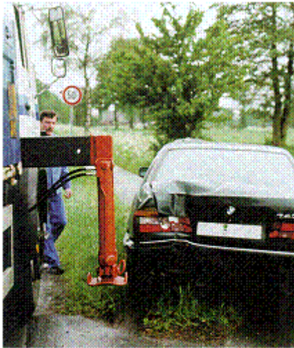
Abb. 270: Ungesicherte Abstützungen können während der Fahrt herausrutschen
