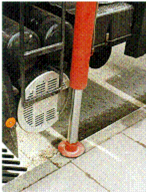
Abb. 165: Unsicheres Abstützen: Stützteller liegt nicht vollständig auf
