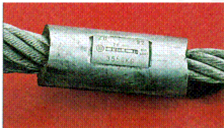
Abb. 218: Vorbildliche Tragfähigkeitsangabe auf einsträngigem Seil
