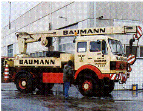
Abb. 6: Lkw-Ladekran mit Teleskopausleger
