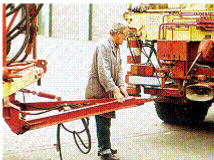
Abb. 275: Verboten: Beim Ankuppeln zwischen den Fahrzeugen stehen
