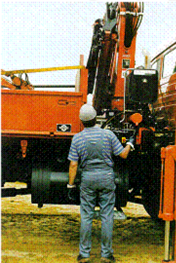
Abb. 143: Richtig: Kran nicht von Ablegeseite aus- bzw. einfalten
