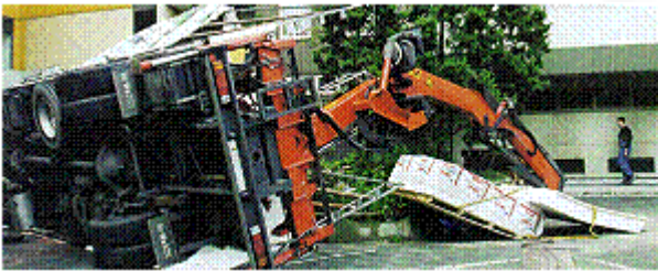
Abb. 157: Nur bei vollständig ausgefahrenen Abstützungen ist der Kran standsicher
