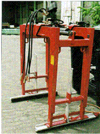
Abb. 190: Steingreifer ohne Umwehrung nur für den Einsatz im bodennahen Bereich
