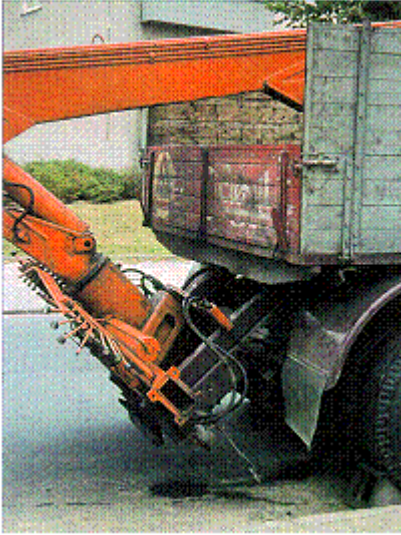
Abb. 147: "Neuartige Konstruktion" nach Unterfahren einer Brücke
