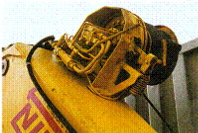
Abb. 109: In den Lastmomentbegrenzer einbezogene Hubwinde
