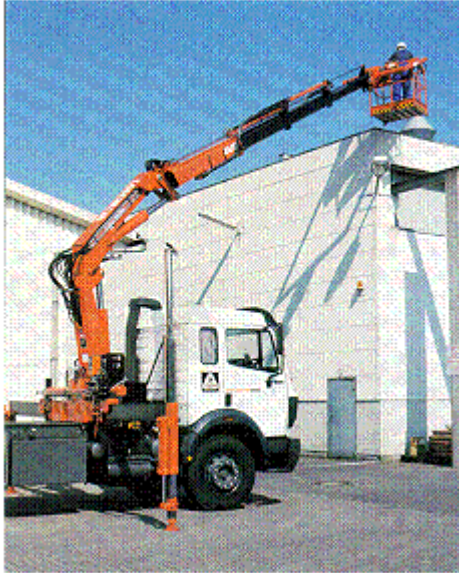
Abb. 185: Personenbeförderung mit Hubarbeitsbühne
