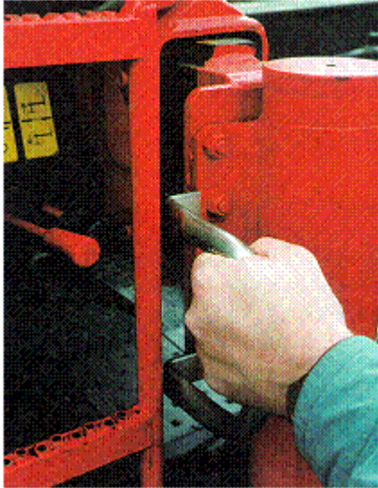
Abb. 38: Quetschgefahr zwischen Handgriff und Leiter
