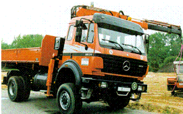
Abb. 151: Rahmenverwindung durch Nichtbenutzen der Abstützung
