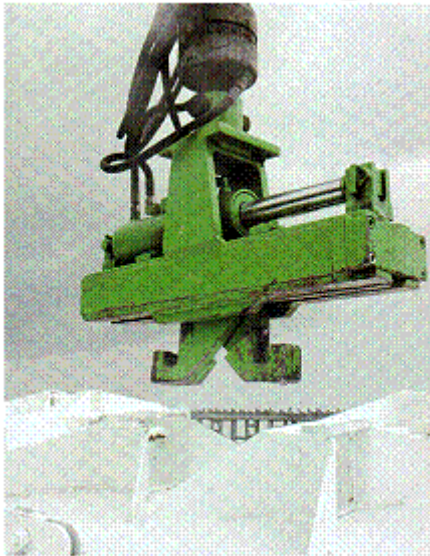
Abb. 199: Lastaufnahmemittel zum Entleeren von Abfall-Sammelcontainern
