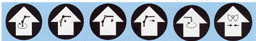
Abb. 84: Normgerechte Anordnung und Kennzeichnung der Stellteile (Steuerhebel)
