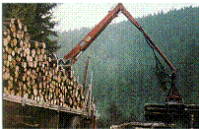
Abb. 160: Gefahr: Bei schräg stehendem Lkw verringert sich die zulässige Kran-Tragfähigkeit
