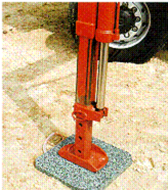
Abb. 162: Vergrößern der Abstützfläche durch Unterbau
