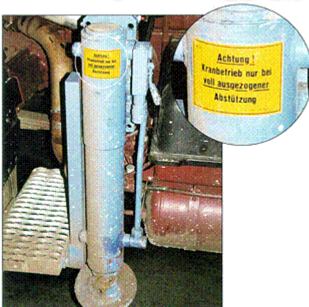
Abb. 153: Zum Abstützen Stützträger voll ausfahren
