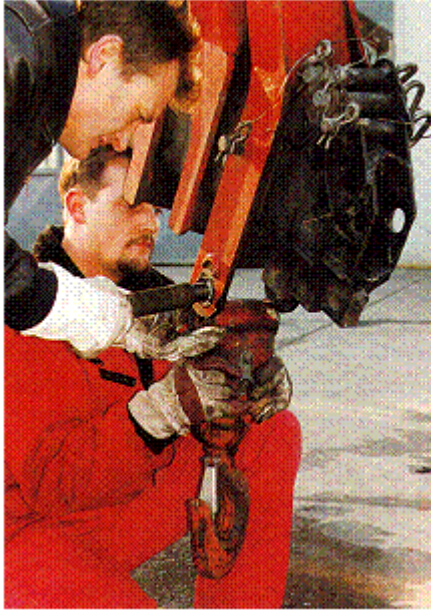
Abb. 58: Montieren des auswechselbaren Lasthakens
