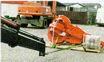
Abb. 144: Lasten nie mit dem Ausleger schleifen
