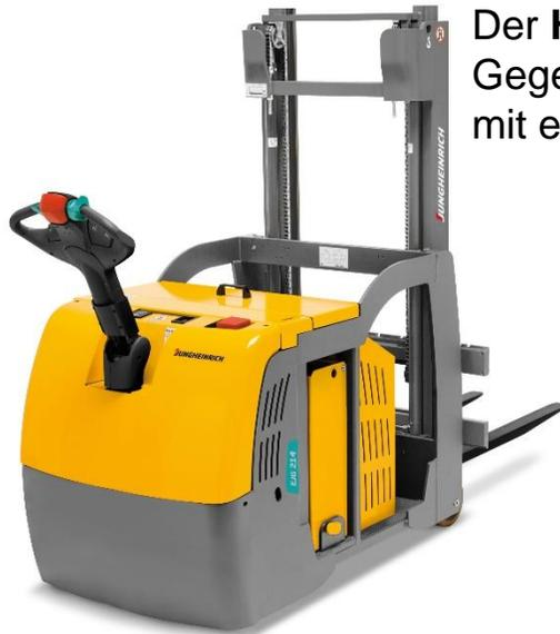
Der **Hochhubwagen** ist im Gegensatz zum Niederhubwagen mit einem Hubgerüst ausgestattet.
