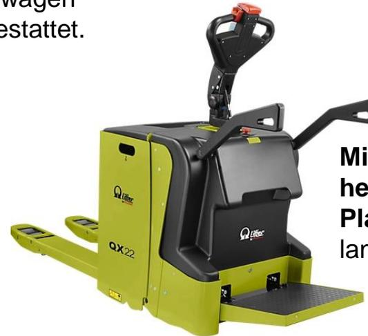
**Mitgänger-Flurförderzeuge mit herunterklappbaren Fahrerstand-Plattform**, erlauben dem Bediener bei langen Fahrwegen das Mitfahren.
